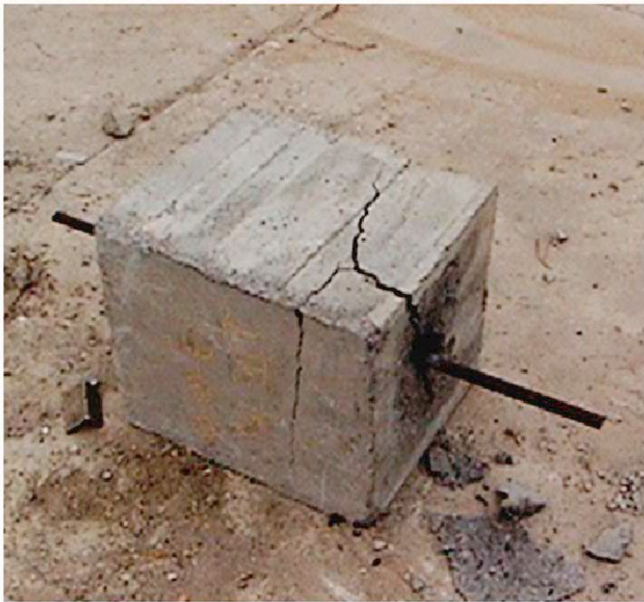
Foto 5.5. Falla por deslizamiento de un anclaje a tensión en un pedestal CON refuerzo de confinamiento.
